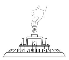
· Instale el cable grueso en el techo atornillándolo o utilizando un kit de suspensión para instalaciones en el techo.
