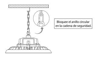
· Compruebe que la fijación es correcta antes de conectar el cableado. Si la luminaria está bien sujeta, proceda a conectarla a la red eléctrica.
